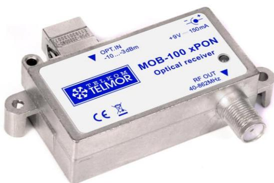
Микроприемник типа **MOB-100xPON** является современным устройством и предназначен для использования в решениях FTTH (*Волокно в дом*), которые применяются параллельно с передачей данных в технологии xPON. Устройство в компактном металлическом корпусе может монтироваться также в пластмассовой коробке. Приемник на входе имеет разъем SC/APC, а на выходе - разъем F
